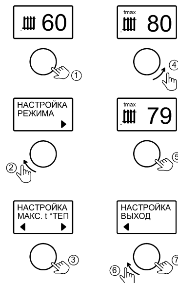
Рисунок 8. Настройка максимальной температуры теплоносителя
